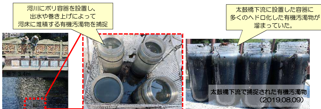
図 28 堆積量調査の実施方法及び太鼓橋下流で捕捉された有機汚濁物（令和元年度）
