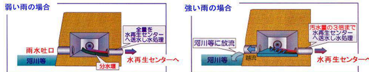
図 4 雨天時における合流式下水道から河川への放流
